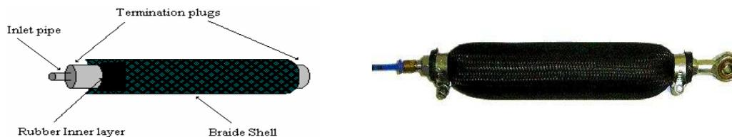
Fig. 3.4.1.1: Pneumatic Muscle Actuator Construction.
